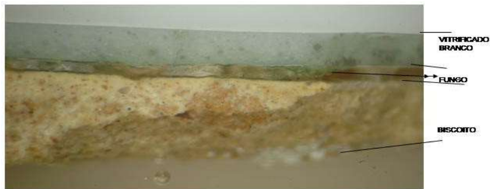
Figura 4: Microfotografia em microscópio estereoscópico onde podemos visualizar a camada de fungo (Fonte: Grifo, 2011)
