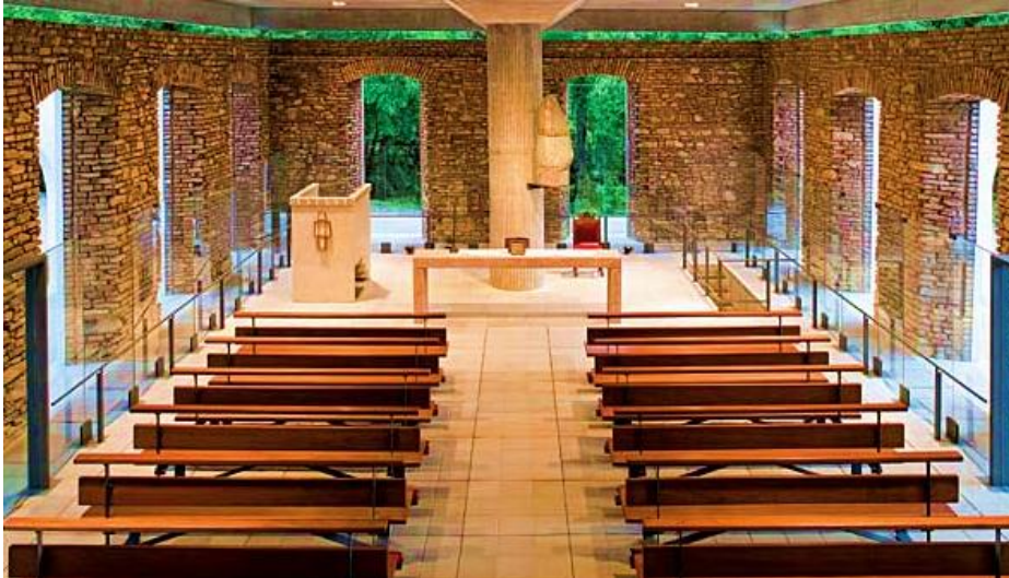
Figura 22 - Capela de Nsa. Sra. da Conceição, Brennand, Várzea. Não se nota os aparelhos de ar-condicionado graças ao inovador sistema de resfriamento pelo chão, o que na foto parece ser o rejunte do piso, trata-se na verdade do espaço por onde o ar sai do subsolo.
