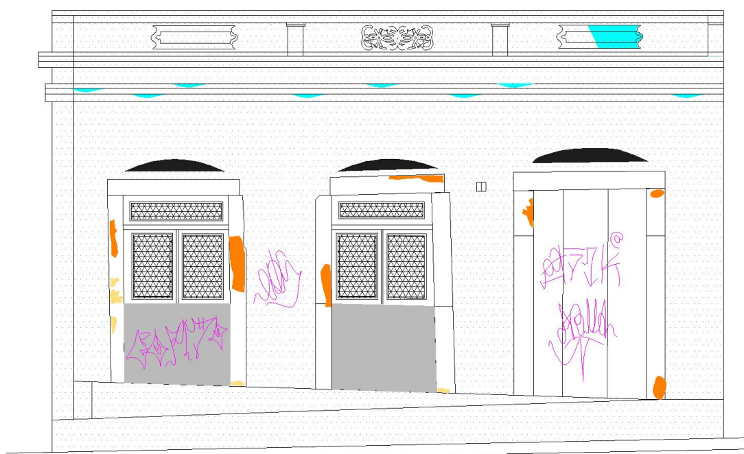
FIGURA 37: Mapeamento de danos, fachada principal, 2015.
