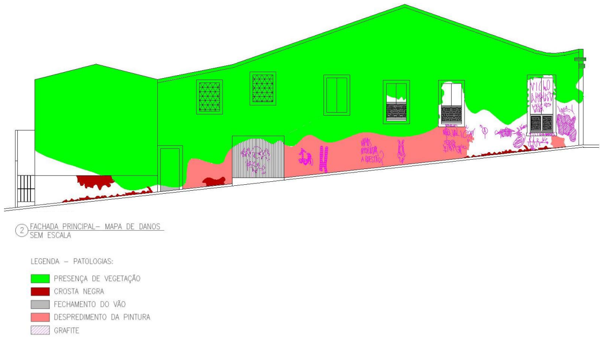
FIGURA 34: Mapeamento de Danos, fachada lateral, 2014.
