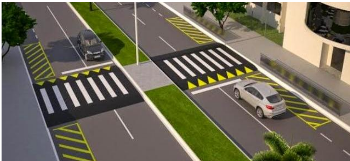
FIGURA 132 – Passagem de pedestres elevada
