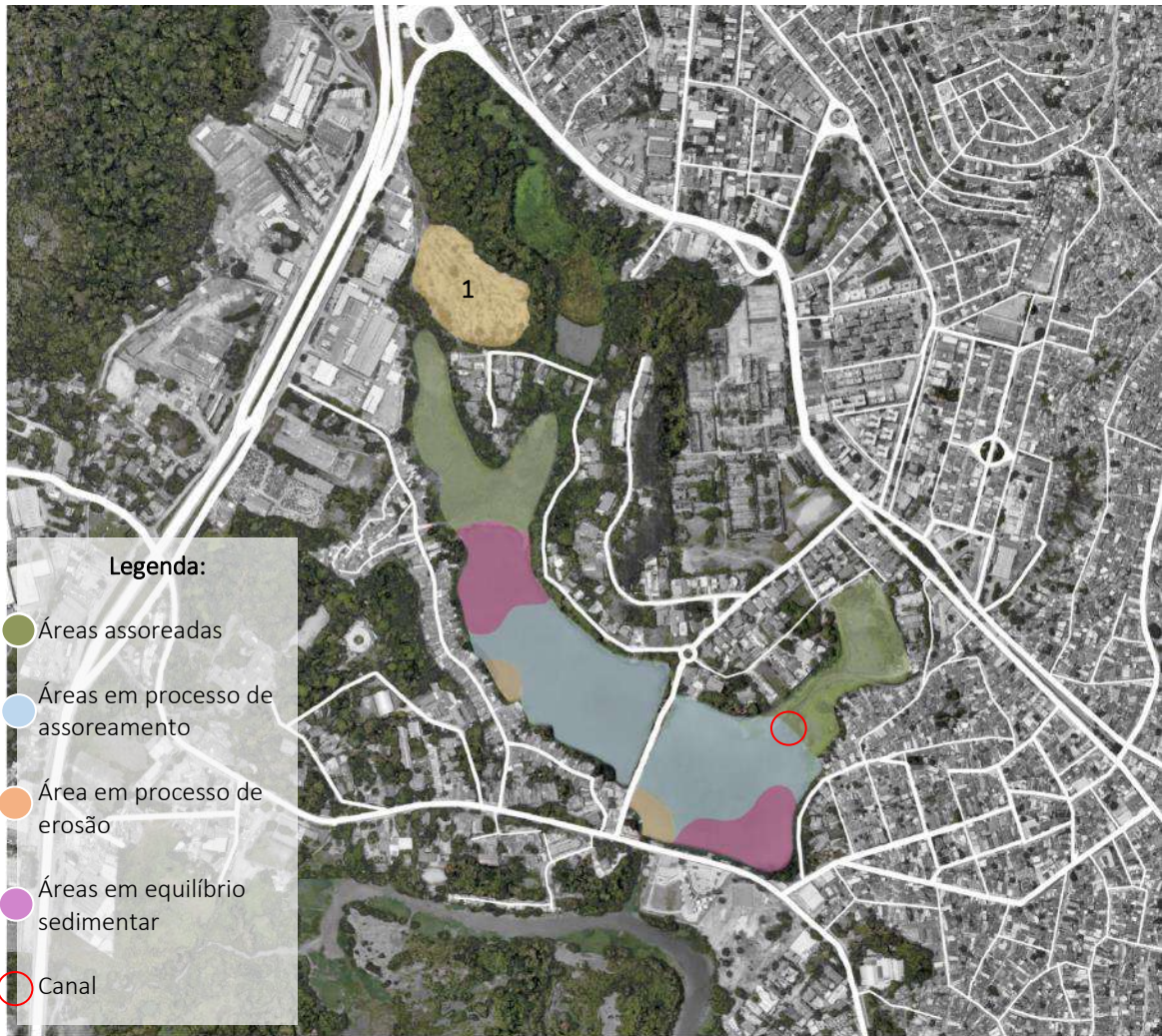
Figura 27 - Síntese da evolução do processo de assoreamento/erosão no açude de Apipucos (1988-2000)
