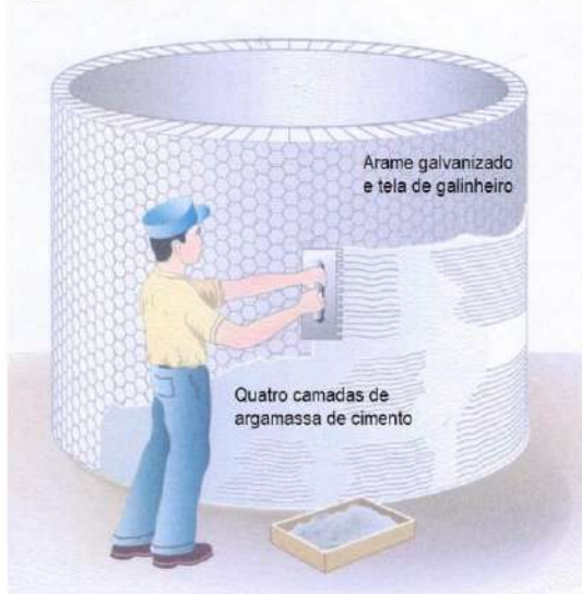
Figura 16 – Cisterna de concreto com arame.
