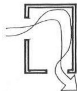
**FIGURA 180:** Ventilação cruzada, em planta
