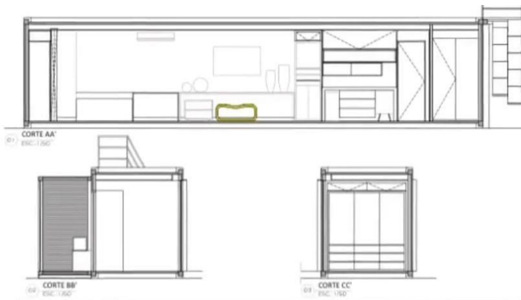
Figura 17 - Corte esquemático casa Guabiraba
