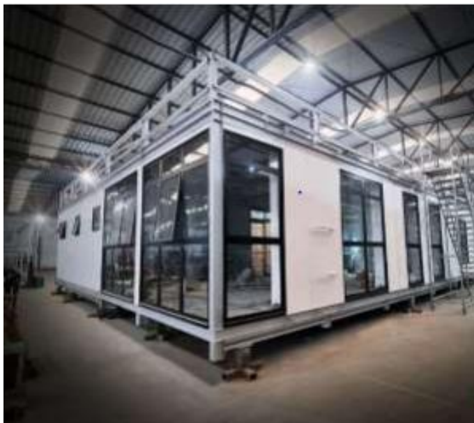
Figura 5 - fabricações de módulo antes de ser instalado no local da obra.
